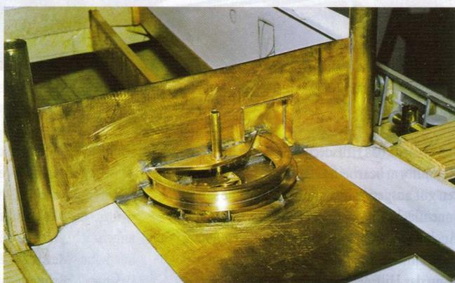
Die Führungsschiene der Schleppwinde wurde zur weiteren Bearbeitung schon mal angelötet
