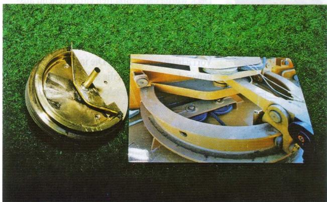
Die eine Hälfte des Rings ist abgetrennt, und die ersten Teile der Schleppvorrichtung sind angelötet. Zum Vergleich die Führungsschiene beim Vorbild
