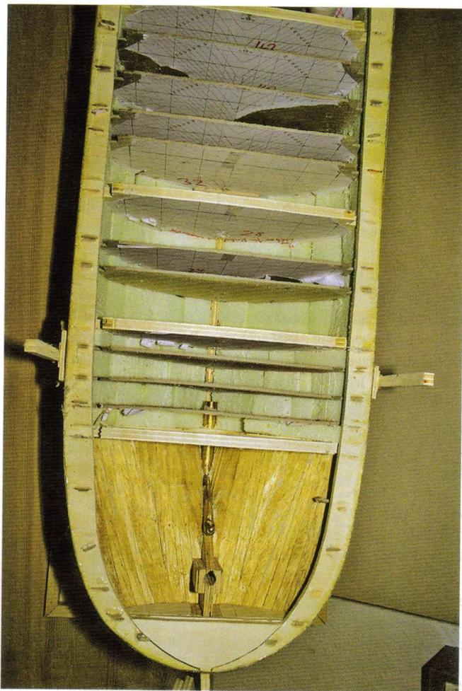
Innenansicht des Bootskörpers: Gut zu erkennen ist das Styropor in den Zwischenräumen. Bug und Heck wurden mit Pappelsperrholz verstärkt
