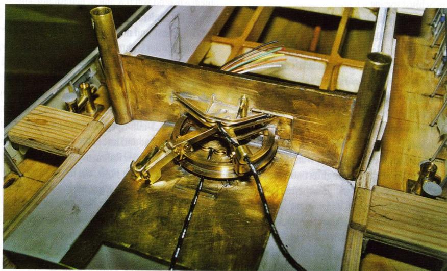
Das Schleppgeschirr mit der Seilführung ist fertig, der Schlepphaken eingepasst, es fehlt nur noch die Auslösevorrichtung
