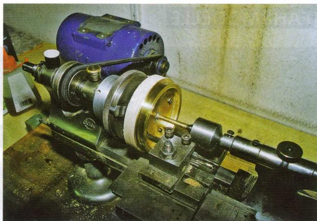
Der Messingring für die Schleppwinde wird auf der Planscheibe innen und außen fertig bearbeitet und dabei mit einer Führungsschiene versehen
