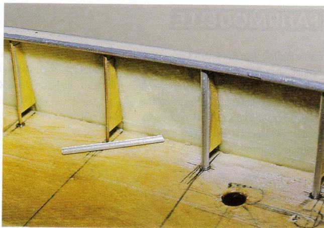
Das GFK-Schanzkleid mit Handlauf und Schanzkleidstützen
